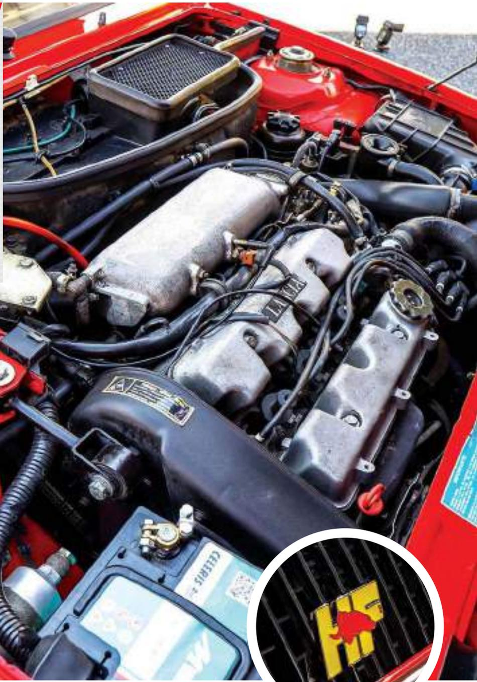
turbo e tutti i componenti interni smontati e controllati. Poi si è provveduto a sostituire paraoli e guarnizioni, candele e relativi cavi, pompa dell'acqua, supporti motore, tutti i filtri oltre alla distribuzione completa. Revisionato anche il cambio, garantendo un funzionamento fluido e preciso. Il resto della meccanica è stato sottoposto ad un'attenta ispezione: sospensioni, pinze
