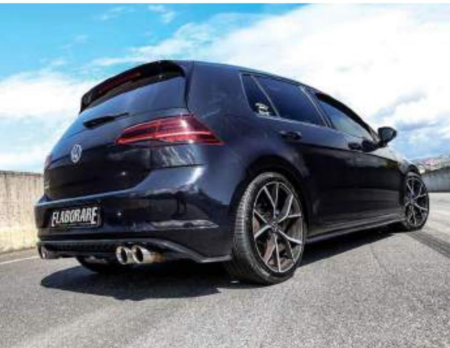
configurazione originale a causa del peso non proprio contenuto. Per ovviare a questo problema, i tecnici della E.A. Racing hanno messo a punto una preparazione tipo "Stage 3" con sostituzione del turbocompressore di serie mutuato direttamente dalla più potente versione 150 CV, ovviamente senza aprire il motore. L'impianto di scarico originale ha lasciato il posto ad uno con diametro da 60 mm, dotato di valvola elettronica per limitare la rumorosità al
