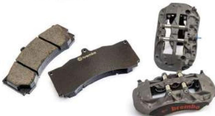
**Codice 3KC80m65A - KIT PISTA FF6 355X32 TY5** composto da dischi 355x32 mm, montati su campana in ergal, pinze a 6 pistoni, staffe. Sono stati utilizzati tubi freno in acciaio e fluido freni Brembo GT | LCF600PLUS specifico per uso racing ed alte temperature.
