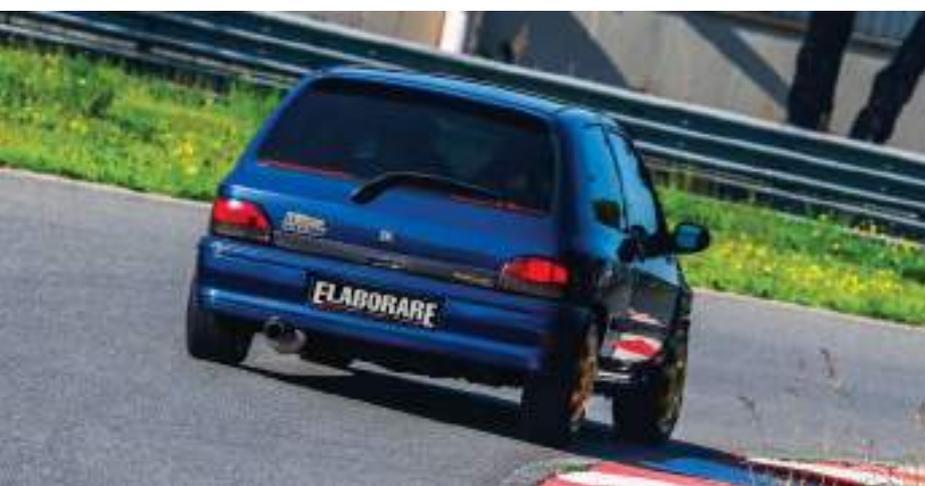
154 CV a 6.174 g/m e limitatore a 7.300 g/m. A livello di ciclistica, la preparazione è più spinta. Il semitelaiο e i bracci sospensione anteriori sono della Clio Williams. Tutti i silent block originali hanno lasciato il posto ad un kit Powerflex, mentre gli ammortizzatori sono i Bilstein B8 abbinati alle immancabili molle Eibach
