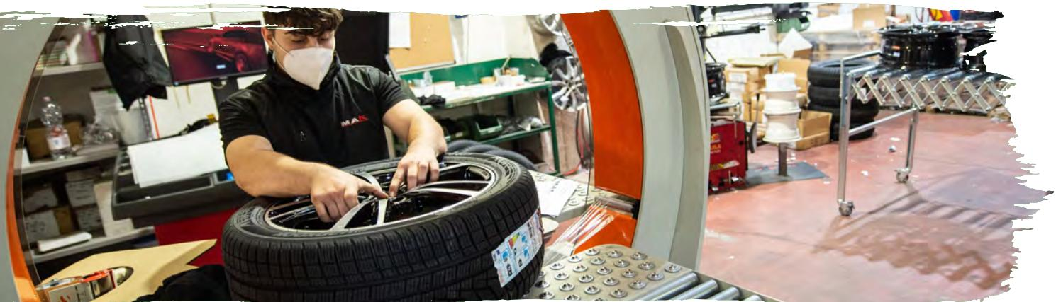
Assembly of complete kit (tyre + wheels + TPMS) / Assemblaggio kit completo (pneumatico + ruota + TPMS)
